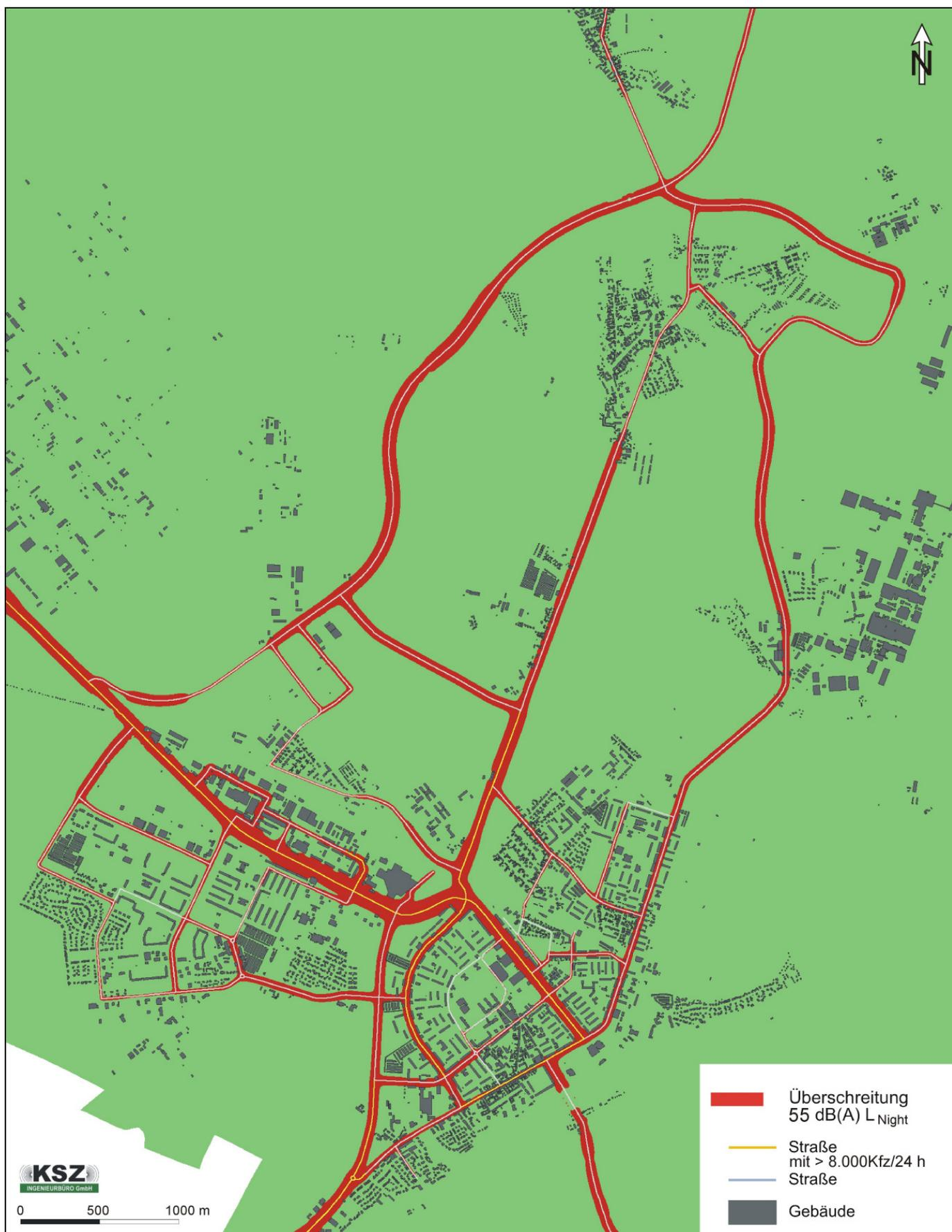
**Anlage C Lärmkarten zur Wirkungsanalyse**
